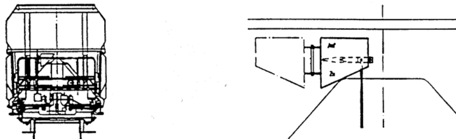
Bild 2: Betätigung der Klappen mit einer Handpumpe unter Bedienung der Handsteuerein- richtung auf der Bühne bei Ausfall der Speicheranlage.
