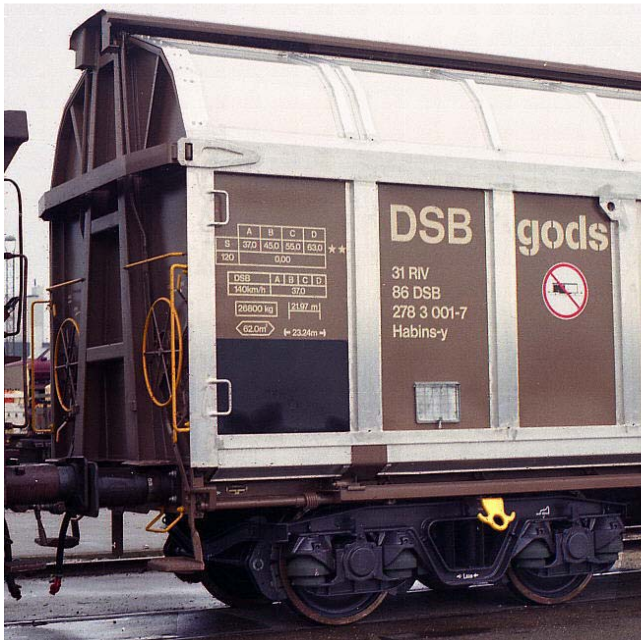
2783001-7 med standardiserede påskrifter og taravægt 26800 kg, Københavns Gb 14.06.1997 © Per Topp Nielsen
